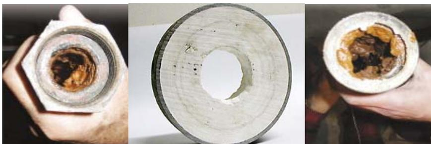
Illustration 1 : Exemples de dépôt de calcaire dans des canalisations
